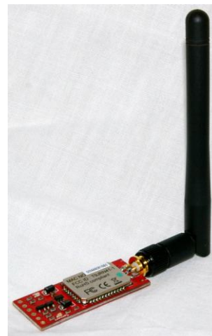
4-5. ábra: A projecthez használt Sparkfun BlueSMiRF modul
