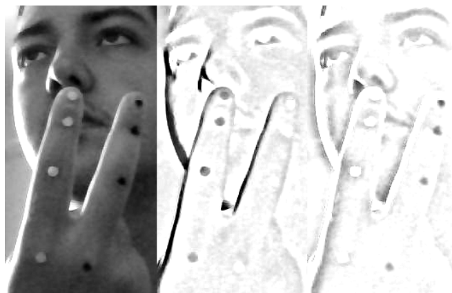
Fig. 4: Az eredeti kép és a kép medián-szűrt változatának különbsége. Bal oldalt az eredeti kép, középen a pozitív előjelű különbség, jobb oldalt a negatív előjelű különbség (minél sötétebb, annál nagyobb).
