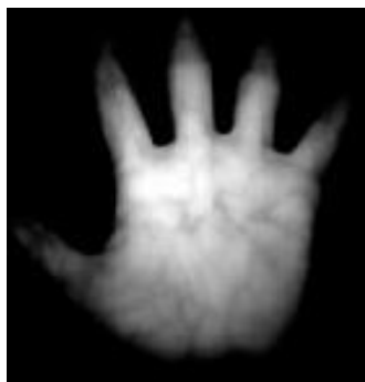
8. ábra. Tenyér vénái infraszkennerrel készült felvételen
