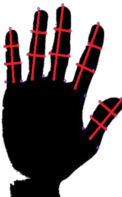
24. ábra. Geometriai jellemzővektor és az előállítása során felhasznált pontok
