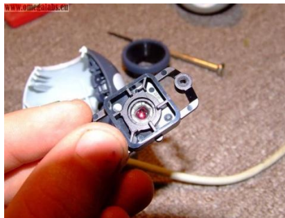
25. ábra: Webkamera IR szűrője [OME]
