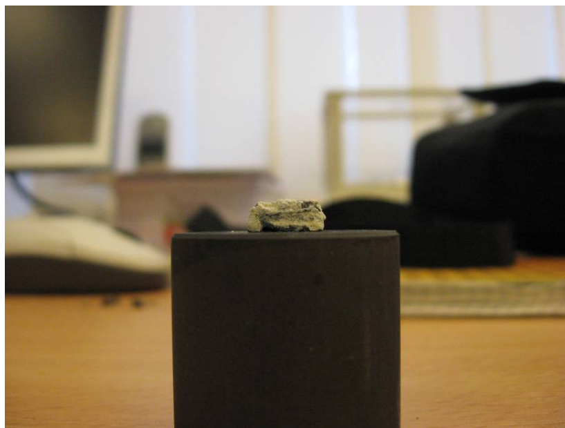
1. ábra: Ekvimoláris KI-KCl – 10% K_2TiF_6 alatt kezelt alumínium a grafittegelyen, tömegarány: 1
