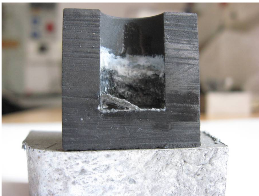
8. ábra: Ekvimoláris KI-KCl – 10% K_2TiF_6 alatt kezelt alumínium a grafittegelyben, tömegarány: 8
