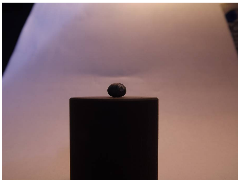
10. ábra: KCl - 10\% K_2TiF_6 alatt kezelt alumínium a tégelyen, tömegarány: 5
