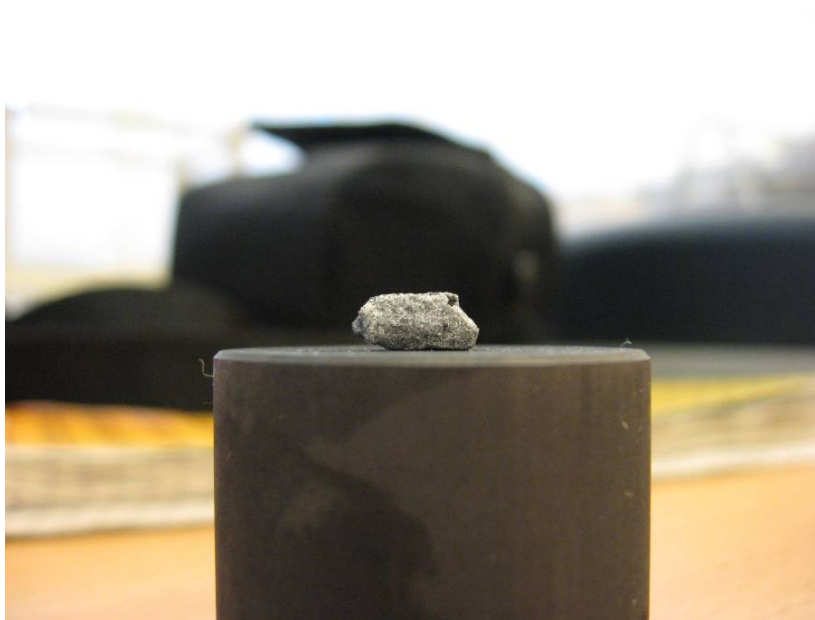
2. ábra: Ekvimoláris KI-KCl – 10% K_2TiF_6 alatt kezelt alumínium a grafittégelyen, tömegarány: 2
