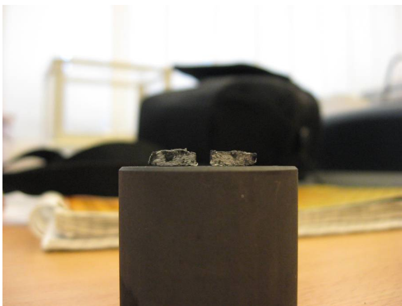
3. ábra: Ekvimoláris KI-KCl – 10% K_2TiF_6 alatt kezelt alumínium a grafittégelyen, tömegarány: 3
