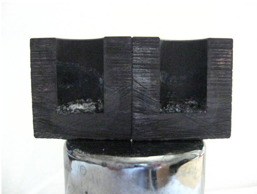
11. ábra: KCl - 10\% K_2TiF_6 alatt kezelt alumínium a tégelyben, tömegarány: 9,37
