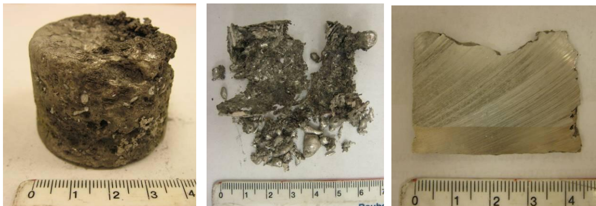
81. ábra ISE_2 minta a) tömbi képe b) téglafalra tapadt maradék c) minta metszet szétüledett fázisokkal
