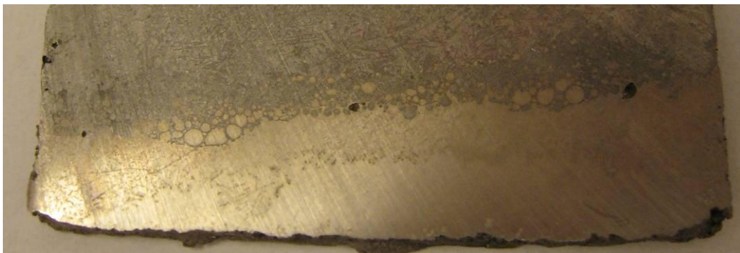
68. ábra A minta kiüledett Bi rétege felett egy jól meghatározható cseppekkel teli sáv jelenik meg; a nagyméretű Si-lapok is látszanak, ami arra utal, hogy a szemcsefinomítás nem sikerült
