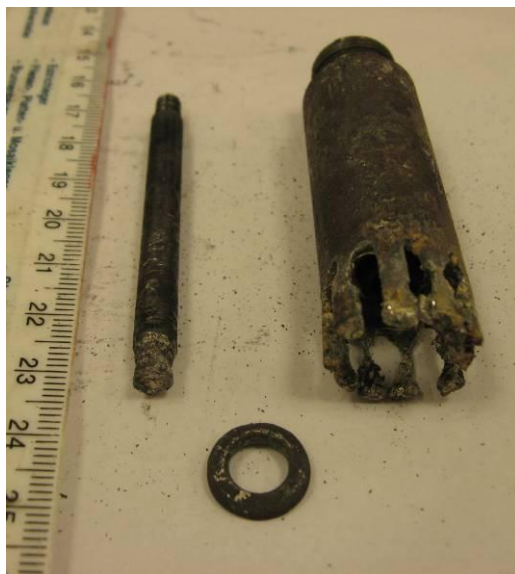
54. ábra Elkopott keverőfej a Si-os kísérlet (ISE_1) után
