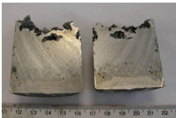
53. ábra Al-28Si + Bi 'in-situ' emulzifikálásával keletkezett, kettévágott minta
