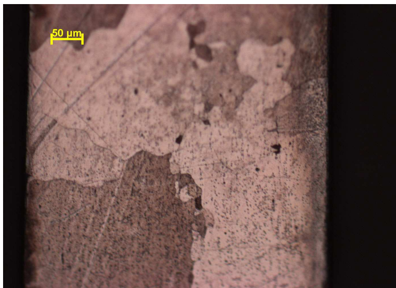
8. ábra 800°C-on hőkezelt darab 200x-os nagyításban
