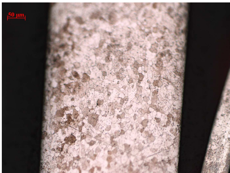
17. ábra 750°C 2 órás darab 200x-os nagyításban ( 50 \mu\text{m} alatti szemcsék)
