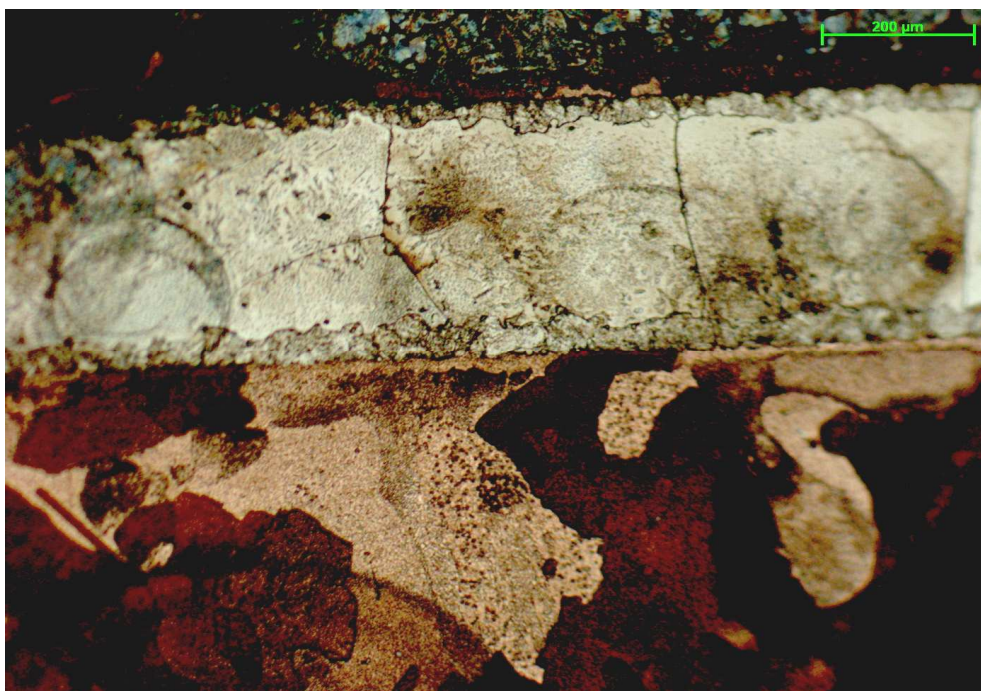
4. ábra Egy rézzel forrasztott minta 200x-os nagyításban
