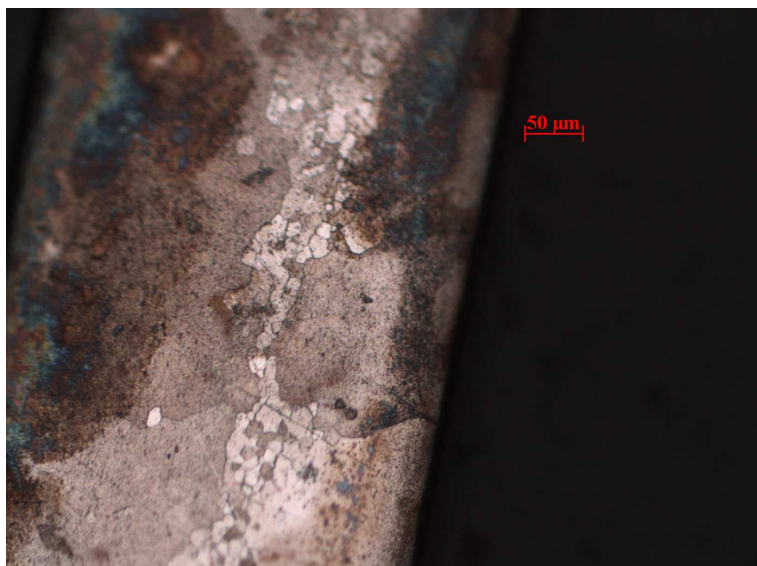
16. ábra 750°C 2 órás darab 200x-os nagyításban (ez azért érdekes része a mérésnek, mert a minta egyik végén 50-100 \mu\text{m} -es szemcsék láthatók, a minta másik végén pedig csak 50 \mu\text{m} alatt)
