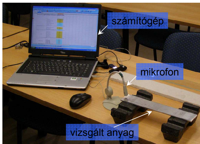
3.1. ábra: Mérési összeállítás longitudinális hullámok detektálásához
