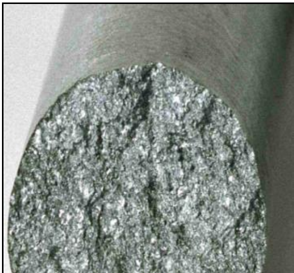
7. ábra: Nem nemesített próbatest töretképe [1]
