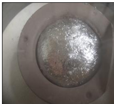
17. ábra: A sűrűség-index meghatározásához használt MK készülék és a vákuumban megszilárdult próbatest [9]
