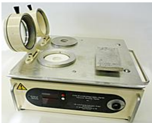
17. ábra: A sűrűség-index meghatározásához használt MK készülék és a vákuumban megszilárdult próbatest [9]
