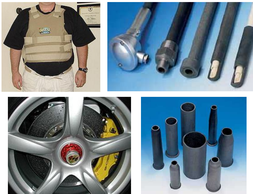
6. ábra. A SiC szerteágazó felhasználási köre 1. [11], [19] (golyóálló mellény, SiC-val burkolt csövek, féktárcsa, égőfúvókák)
