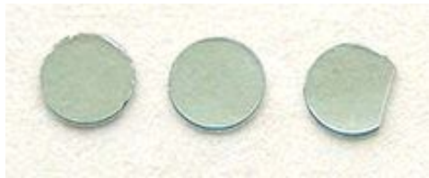
5. ábra. Lely-folyamattal előállított tiszta SiC [11]
