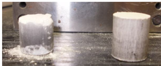
14. ábra. Az 5 m%-os (balra) és 60 m%-os (jobbra) mintadarab préselés után
