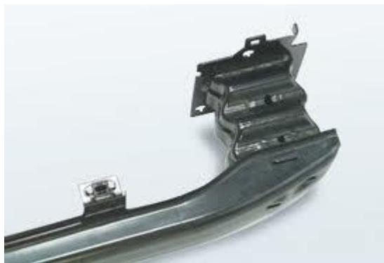
3. ábra ArcelorMittal által gyártott elülső energia elnyelő egység [2]
