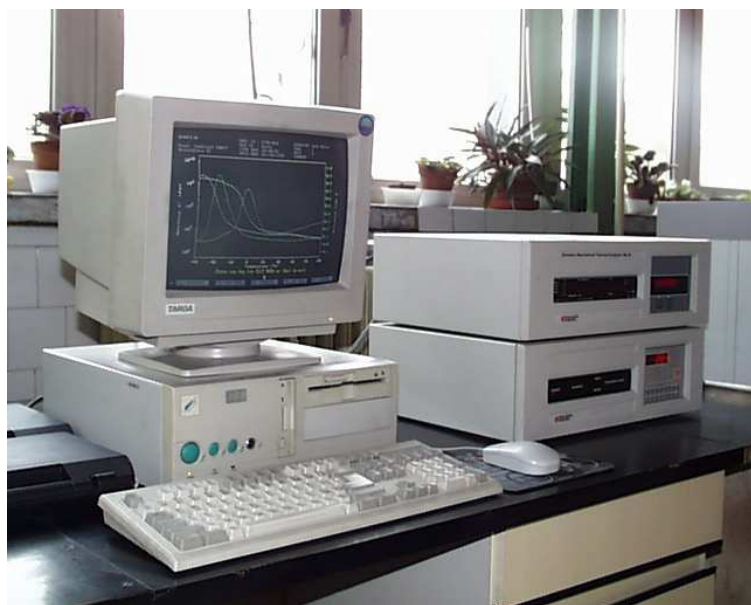
19. ábra: Rheometric Scientific DMTA Mk III (Dynamic Mechanical Thermal Analyser) típusú berendezés
