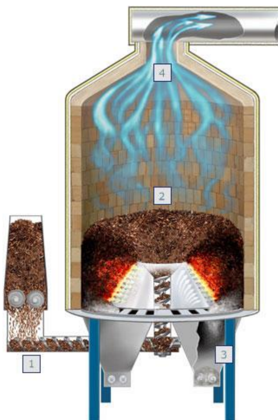
3.3. ábra. Fix ágyas ellenáramú elgázosító rendszer (1) tüzelőanyag betápláló rendszer, (2) elgázosító, (3) hamu eltávolító rendszer, (4) szintézisgáz [21]
