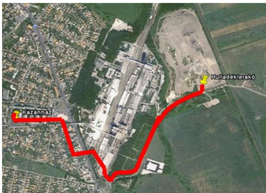
11. ábra: Gázvezeték a hulladéklerakótól a felhasználóig
