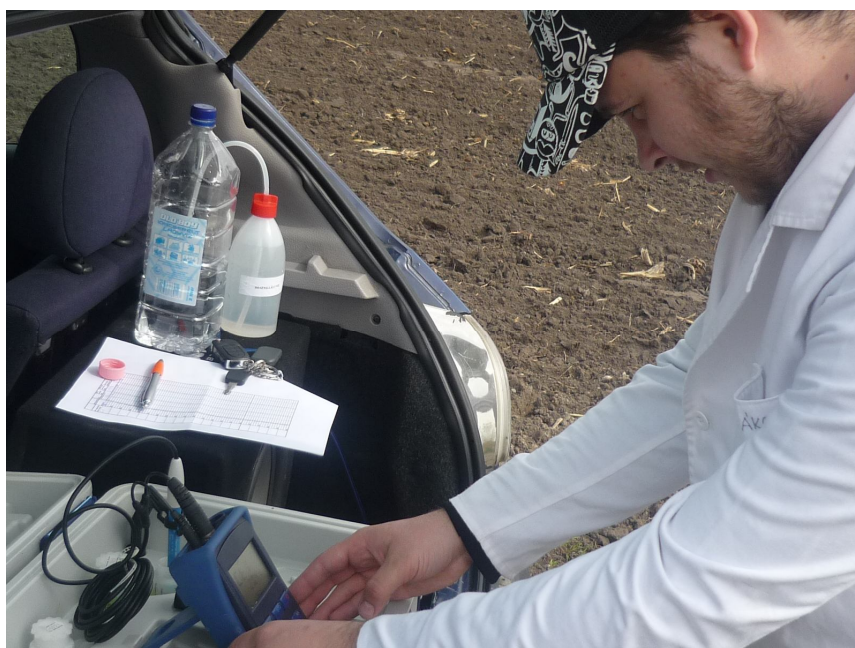
14. ábra Vízminta helyíni vizsgálata MultiLine P4 mérőbőrönddel.
