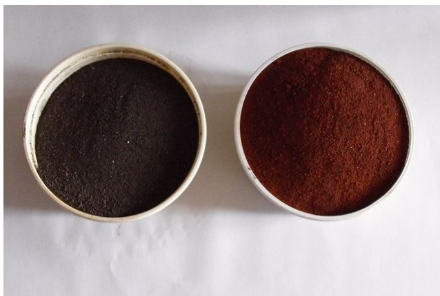
14. ábra Mozsárban összezúzott, majd leszitált minták [Saját kép]
