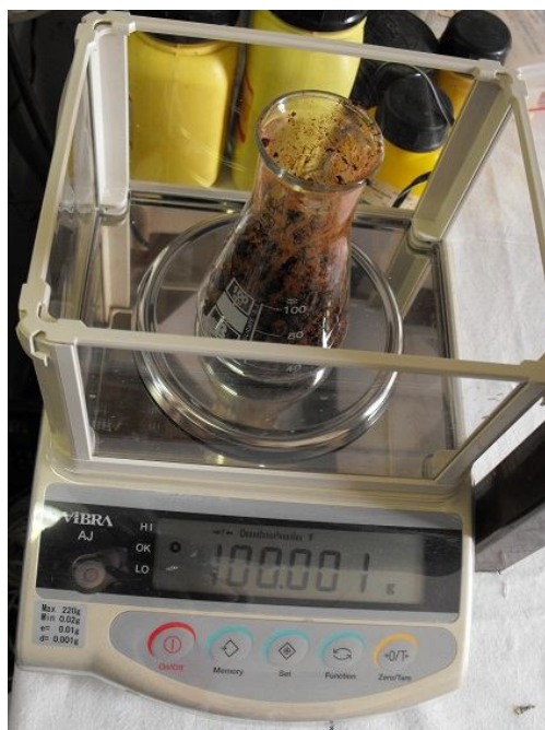
10. ábra Vörösiszap kimérése analitikai mérlegen [Saját kép]
