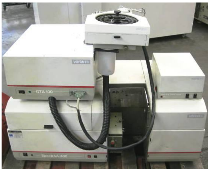
9. ábra Varian SpectraAA 800 atomabszorpciós spektrofotométer [Saját kép]
