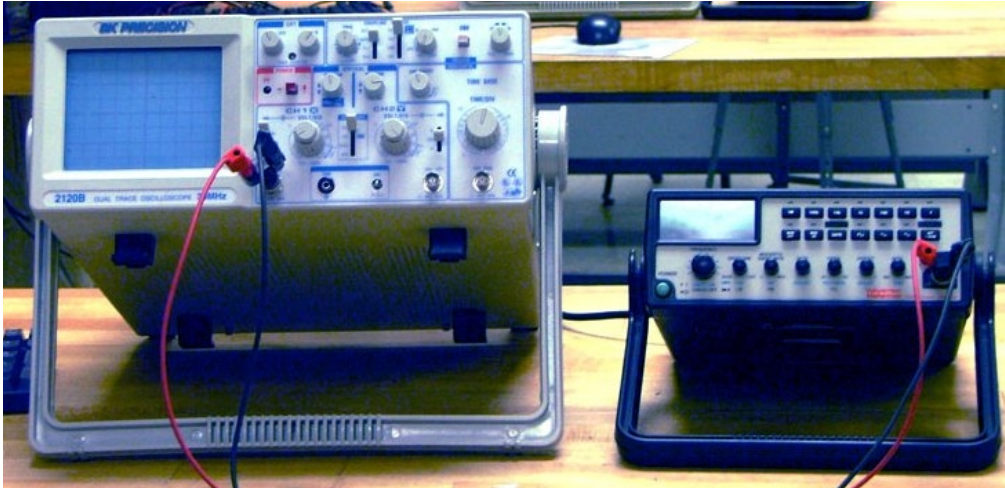
22. ábra: Oszilloszkóp és jelgenerátor (Forrás: http://physics.nyu.edu )
