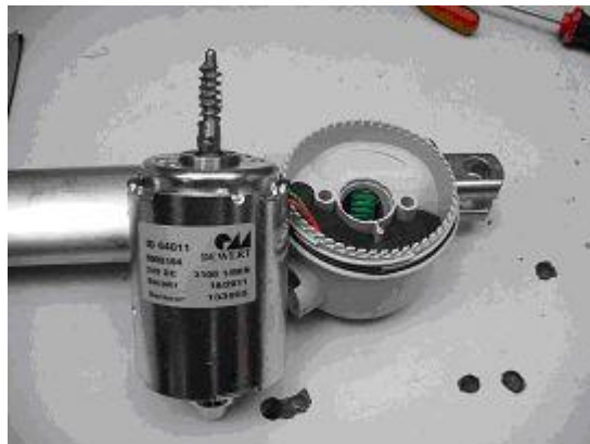
Motorkábel fűzése, kábelleszorító behelyezése
