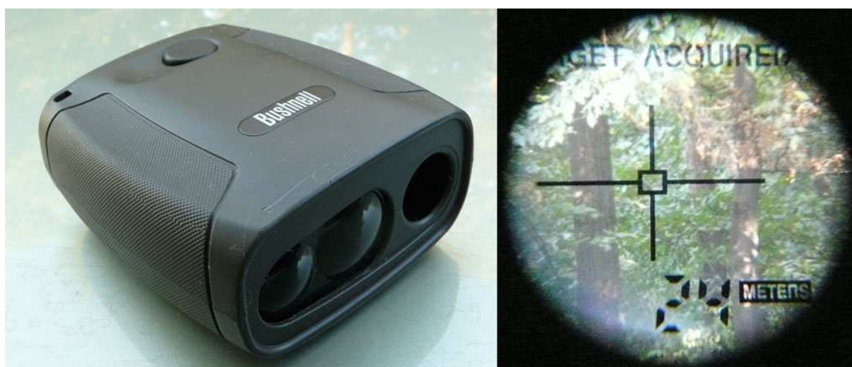
3. ábra: A távolságméréshez használt műszer kívülről és használat közben
