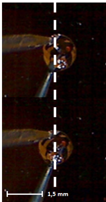
27. ábra. EWOD mozgató strukturálatlan szilícium szeleten
