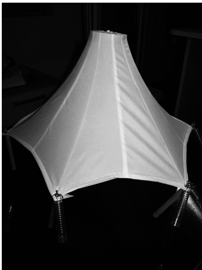
2 egymás melletti kötél eltávolítása oldalnézetből
