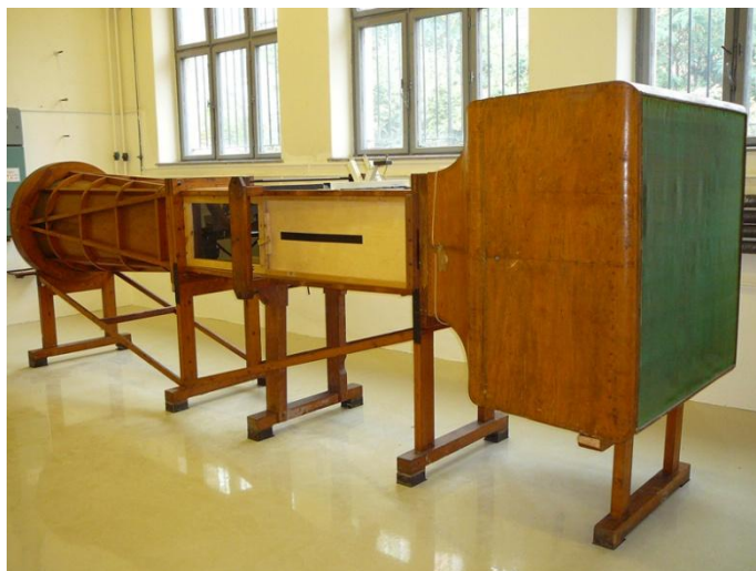
27. ábra Nyitott áramú, szívott üzemi, zárt mérőterű szélcsatorna (BME, Áramlástan Tanszék, Kármán Tódor Szélcsatorna Laboratórium)
