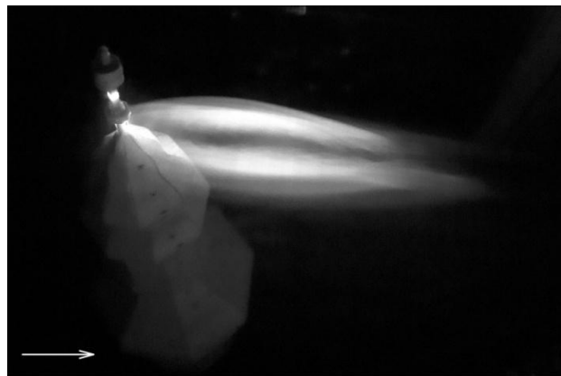
59. ábra A torony „antennája” lézersíkkal megvilágítva
