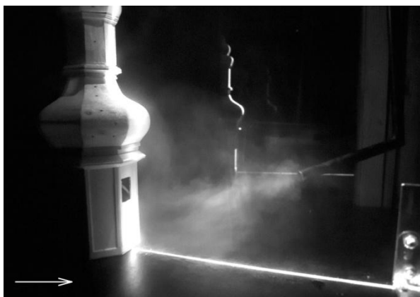
60. és 61. ábra Épületmodell mögötti leválási zóna telítése hátulról olajköd-pipával
