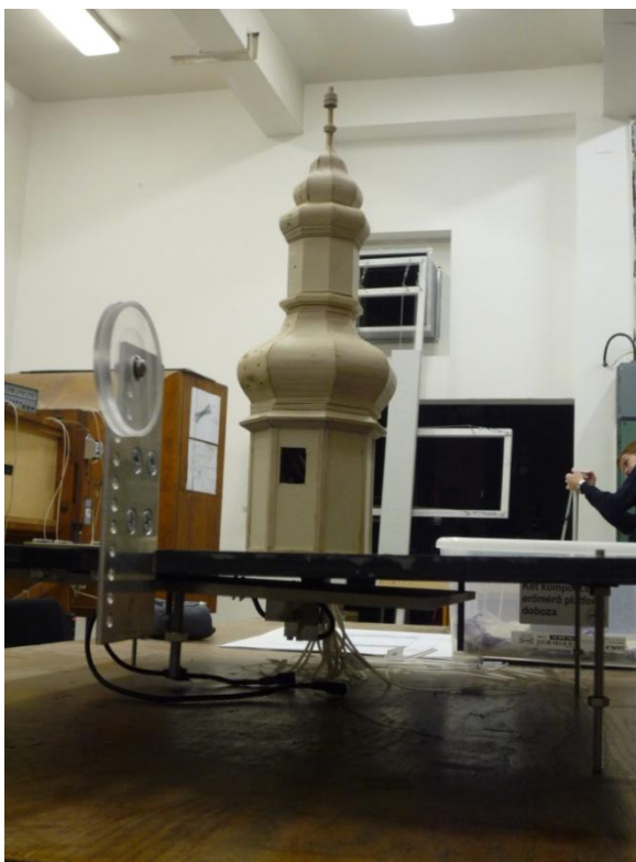
34. ábra Tűztorony makettje a kétkomponensű erőmérő platformmal
