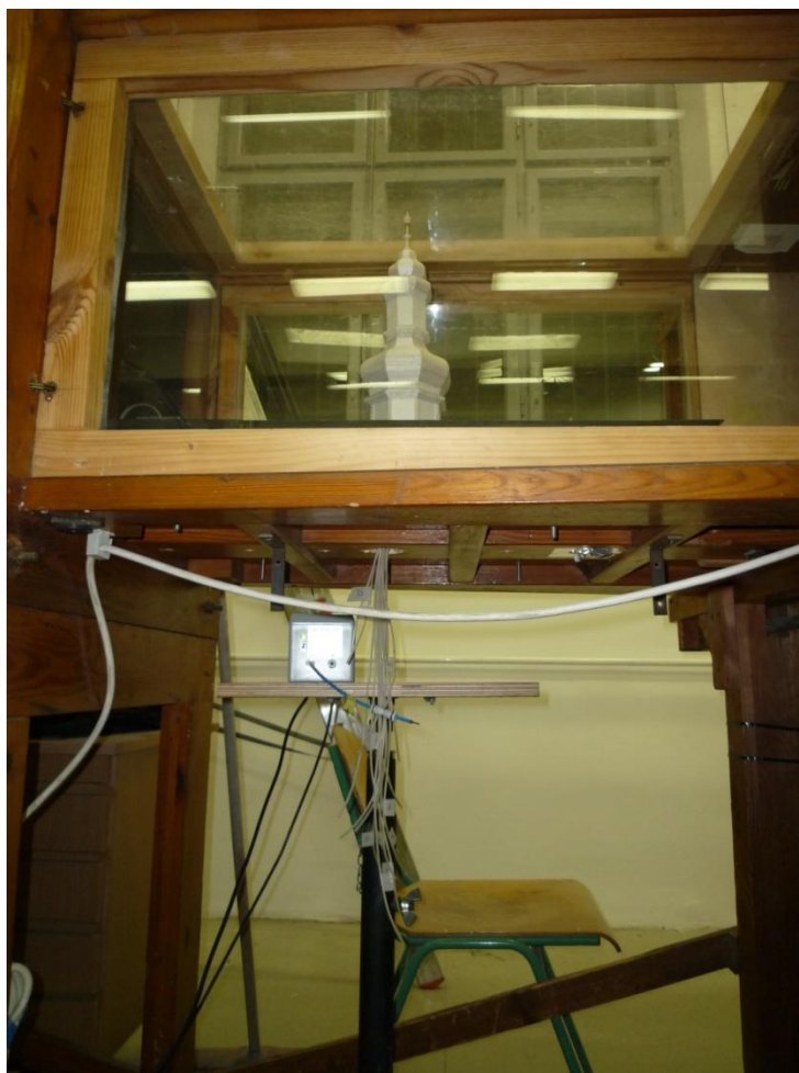
38. ábra Nyomásmérésre előkészített modell a szélcsatornában
