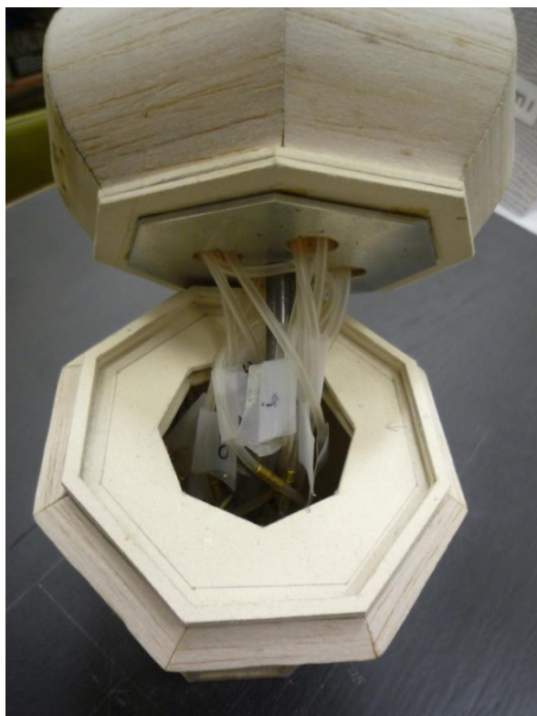
33. ábra Az erőmérő felső, állítható része a toronysisakhoz ragasztva
