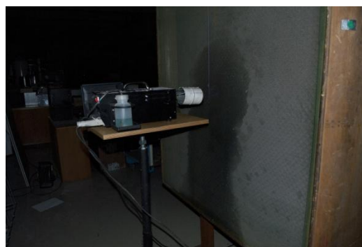
53. ábra Olajködgenerátor a szélcsatorna egyenletesítő kamrája előtt
