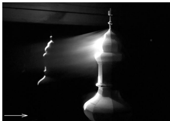
63. ábra A torony tetején az olajköd felkenődik az íveken
