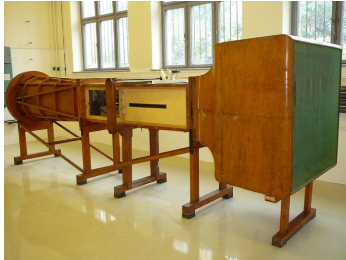
27. ábra Nyitott áramú, szívott üzemű, zárt mérőterű szélcsatorna (BME, Áramlástan Tanszék, Kármán Tódor Szélcsatorna Laboratórium)
