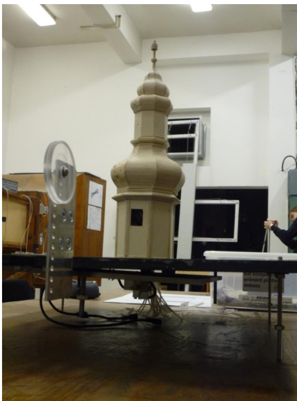
34. ábra Tűztorony makettje a kétkomponensű erőmérő platformmal
