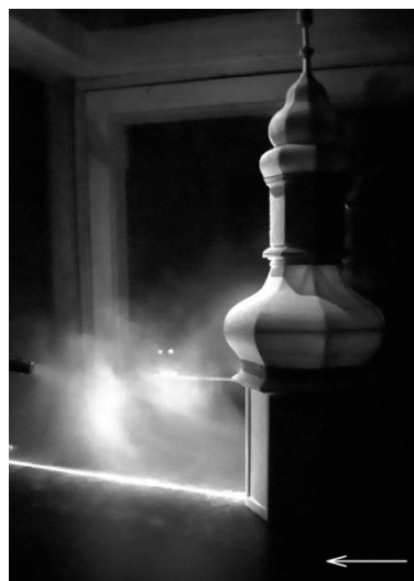
60. és 61. ábra Épületmodell mögötti leválási zóna telítése hátulról olajköd-pipával
