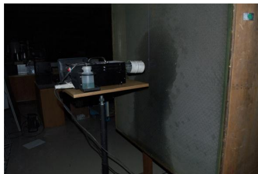
53. ábra Olajködgenerátor a szélcsatorna egyenletesítő kamrája előtt
