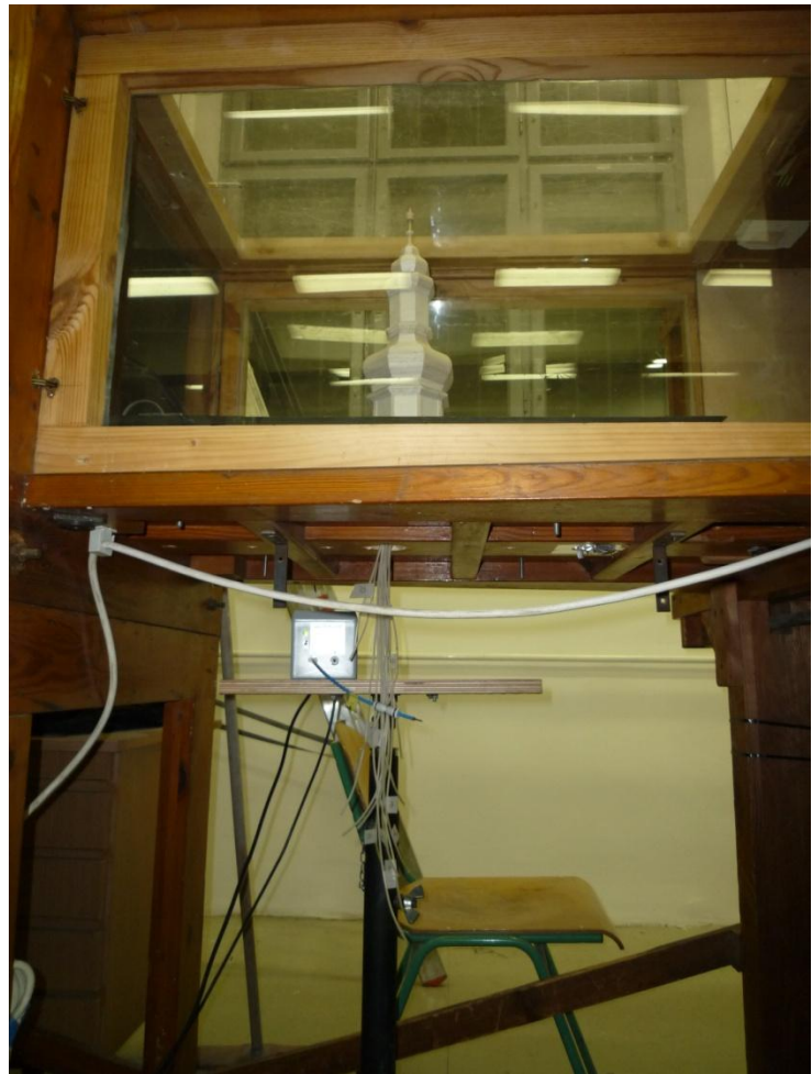
38. ábra Nyomásmérésre előkészített modell a szélcsatornában
