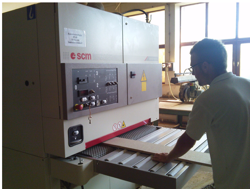
Natúr forgácsalap 17 mm-es vastagságra csiszolása egy SCM Sandya 5S típusú kontaktcsinológépen.
