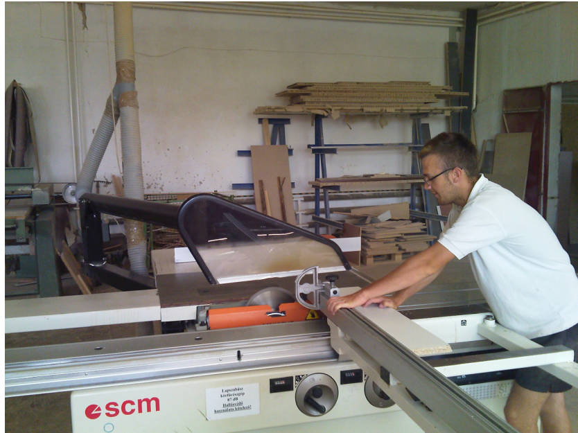
Forgácslap és dekorit lemez méretre szabása egy SCM S400n típusú lapszabásgépen
