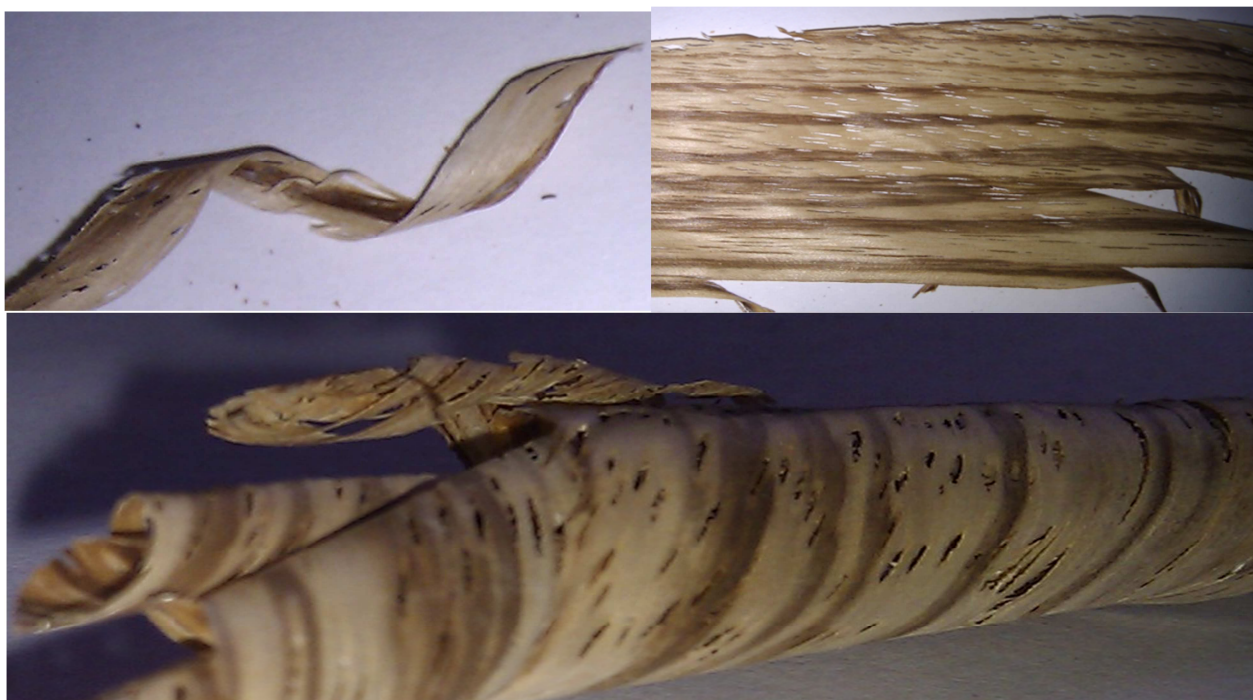
11. ábra A gép által leválasztott forgács
