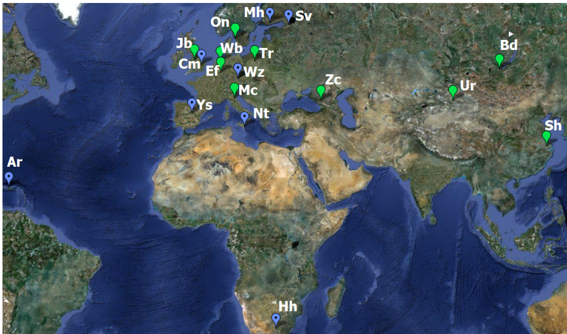
19. ábra. European VLBI Network antennahálózata. 18 független antenna tartozik hozzá, köztük a világ néhány legnagyobb és legérzékenyebb rádióteleszkópja. A 2010-es mérésben részt vett antennákat üres, zöld marker jelöli, a rendszer további elemeit pedig kék, közepén pöttyel.
