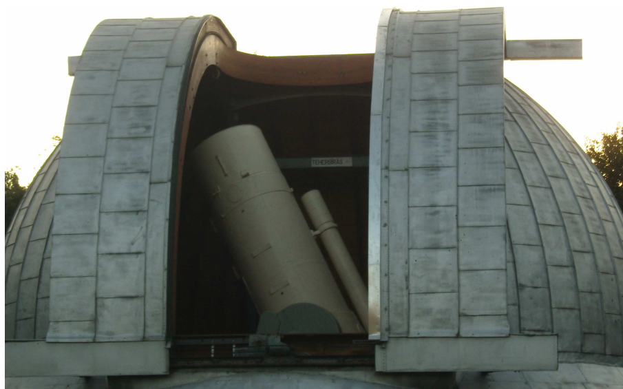
6. ábra: A Schmidt rendszerű 60/90/180 cm-es távcső Piskés-tetőn, mellyel az optikai mérések készültek.
