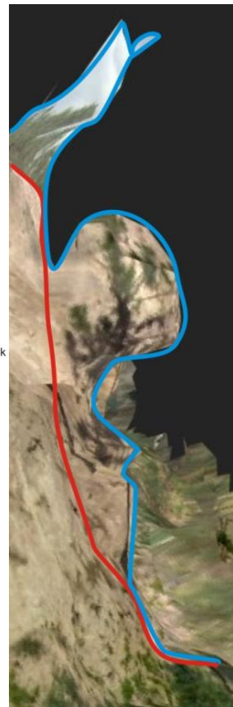
25. ábra: A modell hibái. Pirossal jelöltem a lavaka eredeti falát, kékkel, pedig a növényzet és az ég hatására kialakult ettől eltérő modellezett falat.
