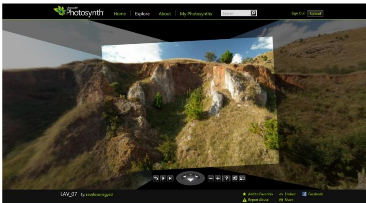
21. ábra: A PhotoSynth megjelenítési formája eltér a hagyományos programoktól, mivel nem egy valódi 3D képet kapunk, csupán az eredeti képek tájolását és az egymáshoz viszonyított elfordítását végzi el.
