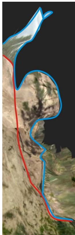
26. ábra: A modell hibái. Pirossal jelöltem a lavaka eredeti falát, kékkel, pedig a növényzet és az ég hatására kialakult hibás falat.
