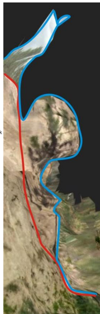
25. ábra: A modell hibái. Pirossal jelöltem a lavaka eredeti falát, kékkel, pedig a növényzet és az ég hatására kialakult ettől eltérő modellezett falat.
