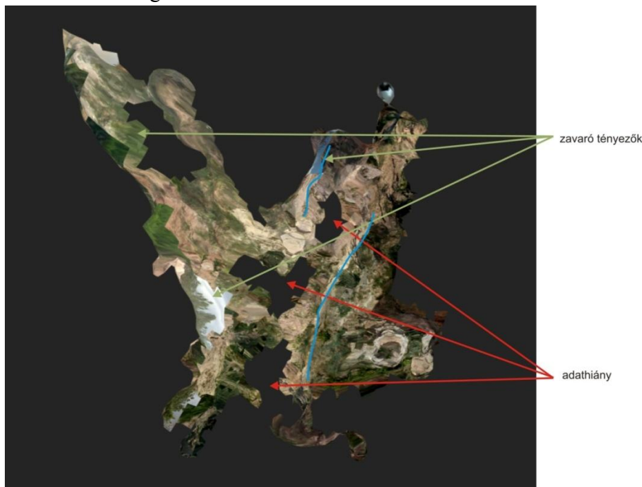
26. ábra: 17 képből készített ortofotó. A felülnézeti képen látható, hogy a gerincmaradványok (kék görbe) takarásában lévő területek igen adathiányosak (piros nyilak). A modellt továbbá befolyásolta a lavaka dús növényzete és az ég (zöld nyilak).
