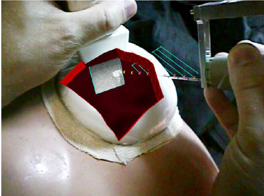
16. ábra - Mind az ultrahangos szonda, mind a tű nyomkövetve van. A rendszer jelzi a tű síkbeli vetületét az ultrahangos szeletbe (kék vonalak), valamint megjeleníti a tű tervezett pályáját az adott pillanat szerint.
