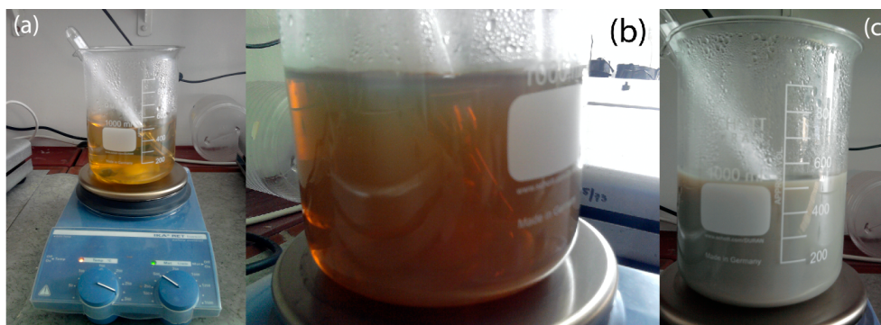
6. ábra: A Lee - Meisel oldat elkészítésének fázisai. Az ezüst-nitrát és a desztillált víz keveréke teljesen átlátszó, majd a nátrium-citrát hozzáadása után először borostyánszínűvé válik (a), aztán pár percen belül sárgászöld (b) és végül zöldes színű (c) lesz.
