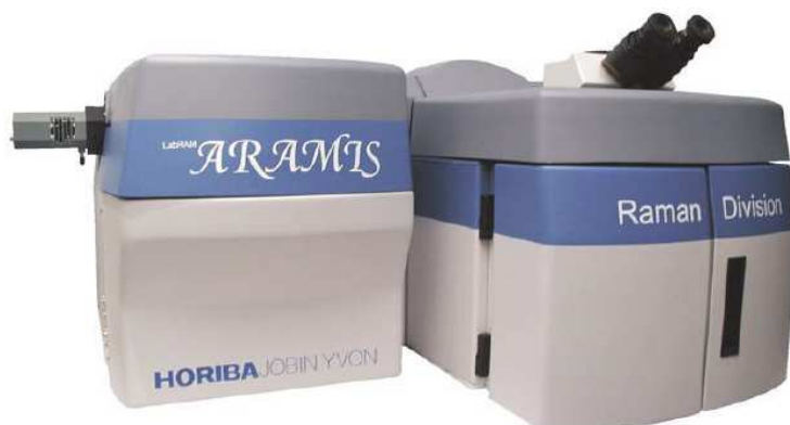
5. ábra. A HORIBA Jobin Yvon cég LabRAM ARAMIS típusú Raman eszköze, amellyel a méréseimet végeztem.
