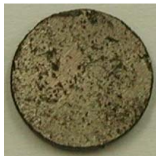
2.3. ábra Az őrleményből 6mm átmérőjű és ~1mm vastag korongok készülnek
