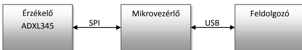
5.2 ábra. Mérésegység elméleti felépítése.
