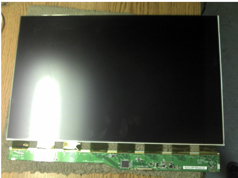
13. ábra LCD megjelenítő panel
