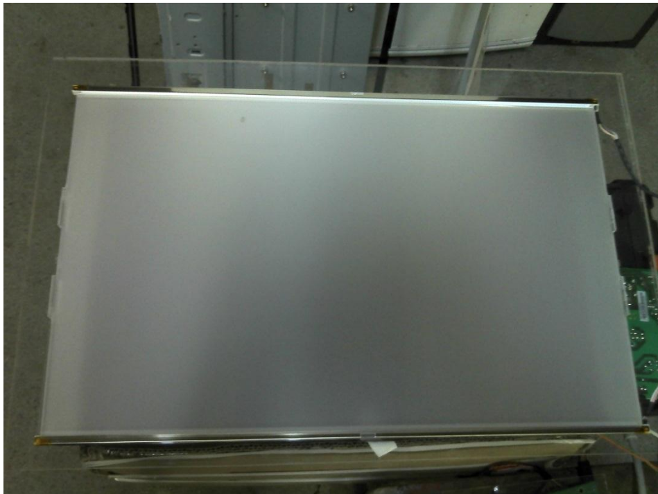
12. ábra LCD háttérvilágítás
