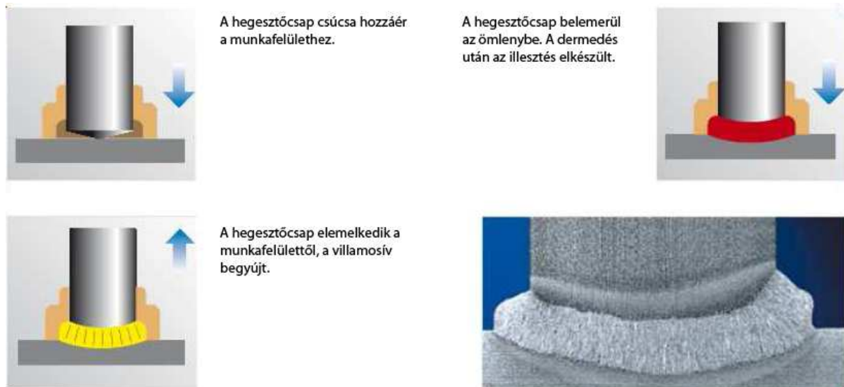
4. ábra Kerámiagyűrűs ívhúzásos csaphegesztés munkafolyamata és varratminta
