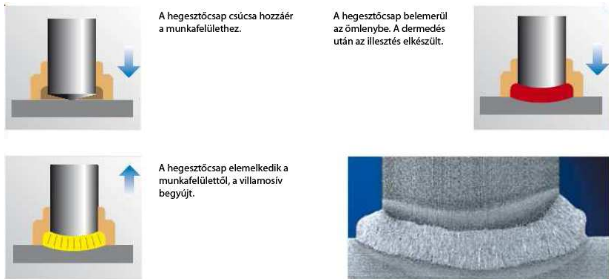
4. ábra Kerámiagyűrűs ívhúzásos csaphegesztés munkafolyamata és varratminta
