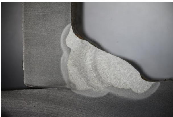
18 ábra MAG eljárás varratalakja PF pozícióban
