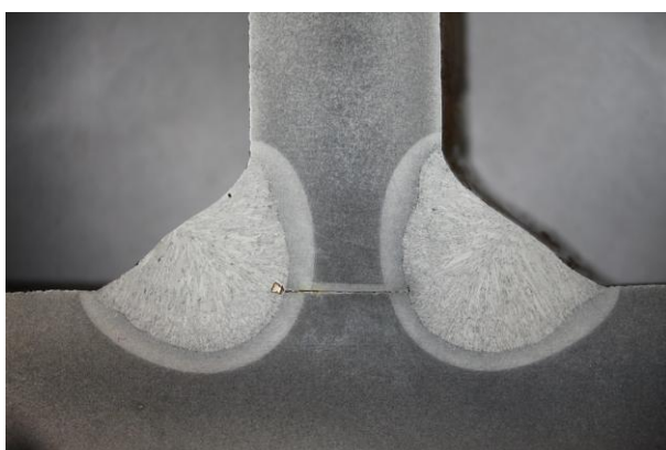
23. ábra FH eljárás PB, kétoldali sarokvarratnál
