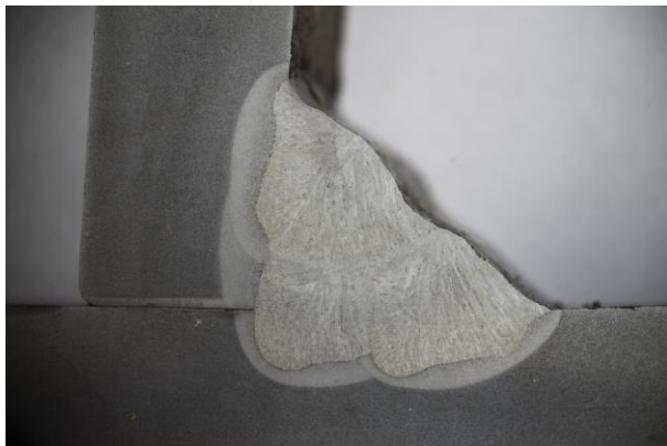
15. ábra MAG eljárás varratalakja PB pozícióban
