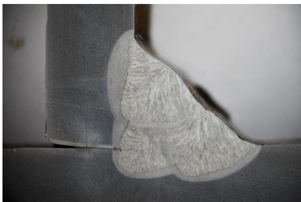
16. ábra PCS eljárás varratalakja PB pozícióban
