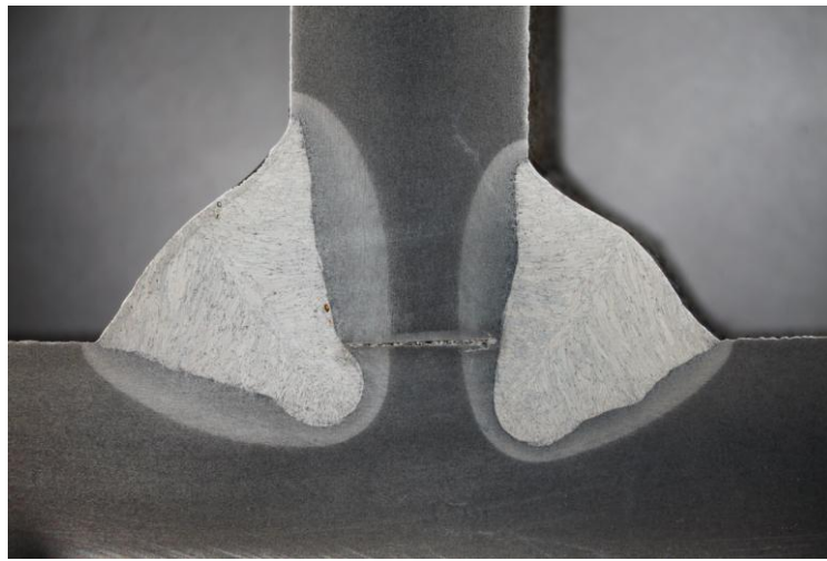
29. ábra A PCS eljárás jellegzetes varratlakja (PCS – 2 PB kísérlet)
