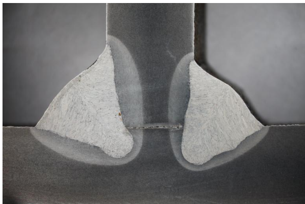
22. ábra PCS eljárás PB, kétoldali sarokvarratnál
