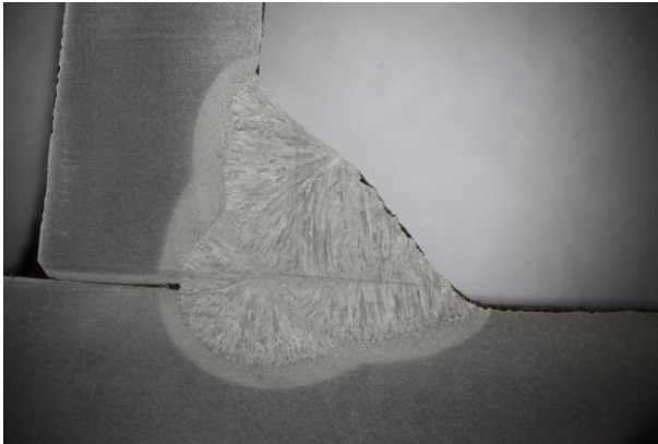
17. ábra FH eljárás varratalakja PB pozícióban
