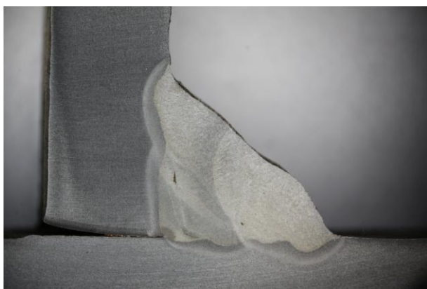
19. ábra PCS eljárás varratalakja PF pozícióban
