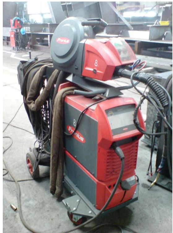
10. ábra A TransSteel 5000 hegesztőberendezés
