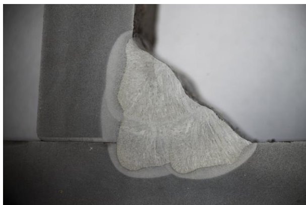
15. ábra MAG eljárás varratalakja PB pozícióban
