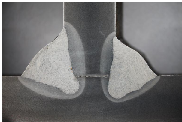
22. ábra PCS eljárás PB, kétoldali sarokvarratnál
