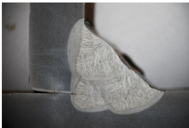
16. ábra PCS eljárás varratalakja PB pozícióban
