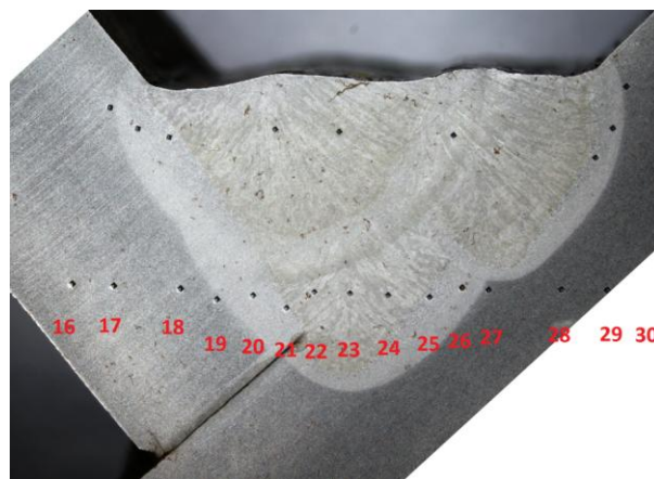
24. ábra Keménység-eloszlási diagram a megjelölt mérési sor szerint
