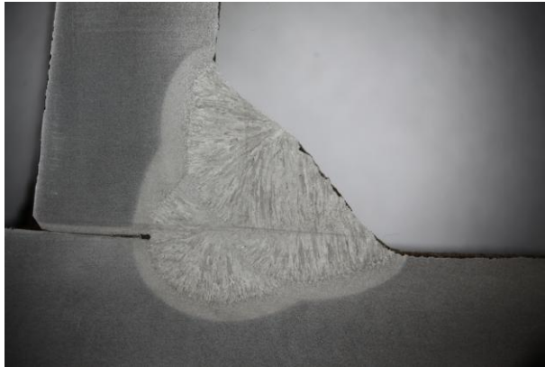
17. ábra FH eljárás varratalakja PB pozícióban
