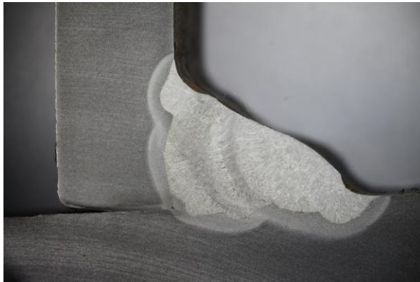
18 ábra MAG eljárás varratalakja PF pozícióban
