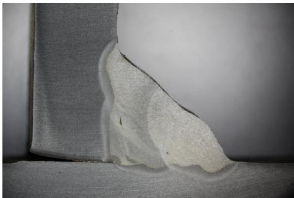
19. ábra PCS eljárás varratalakja PF pozícióban
