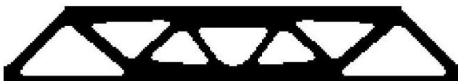
16. ábra. BESO megoldása (2,365 Nmm; 200(37)) ER=5\% ; AR_{\max}=5\%
