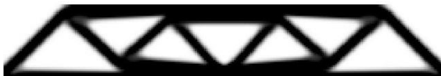
15. ábra. SIMP megoldása (2,551 Nmm; 200(30)) r_{\min}=3,0 \text{ mm}
