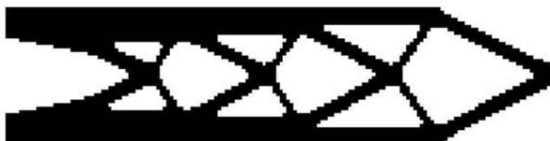
10. ábra. BESO megoldása (181,4 Nmm; 200(33)) ER=2,0%; AR max =50,0%
