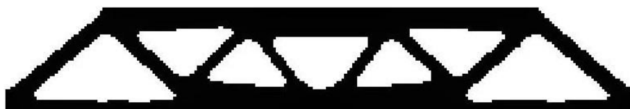
18. ábra. QSQF megoldása (2,38 Nmm; 200(79), inv.pow) V_0=0,7 ; ER=5\% ; H_s=0,5 ; H_d=0,4 (it. < 40); \beta=3,5,7...
