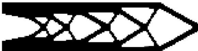
11. ábra. QSQF megoldása (181,3 Nmm; 200(31), pcw.), V_0=0,55 ; ER=1,5%; H_s=0,5 ; H_d=0,5 (it.<30); \beta=4,6,8\dots
