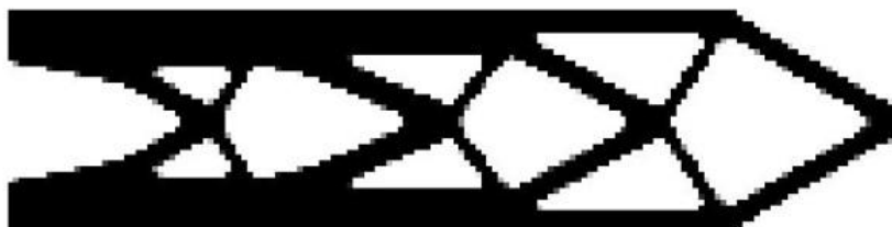
12. ábra. QSQF megoldása (182 Nmm; 200(52), pcw.) V_0=0,55 ; ER=1,5%; H_s=0,5 ; H_d=0,5 (it.<30); \beta=4,5,6\dots
