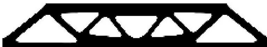
16. ábra. BESO megoldása (2,365 Nmm; 200(37)) ER=5\% ; AR_{\max}=5\%
