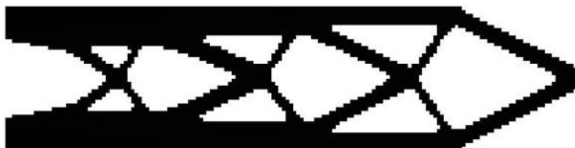
13. ábra. QSQF megoldása (184 Nmm; 200(52), inv.pow), V_0=0,7 ; ER=1,5%; H_s=0,5 ; H_d=0,4 (it.<40); \beta=4,5,6\dots
