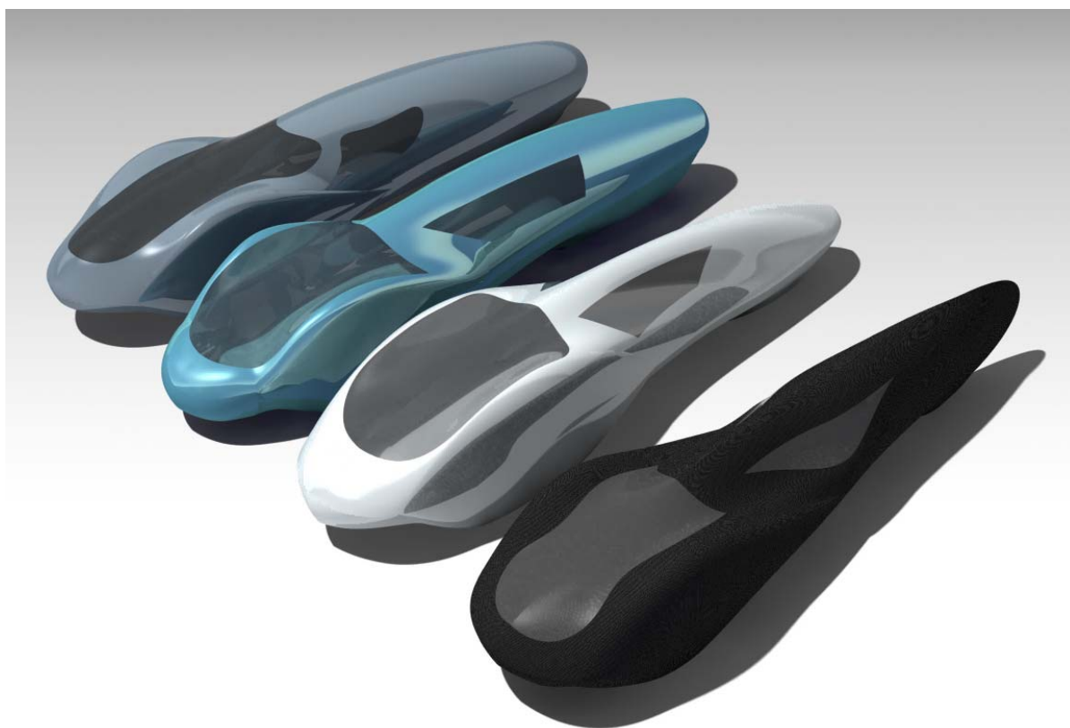
3.3.1 ábra. Team Orca csapat csökkentett légellenállású karosszériaváltozatai.
