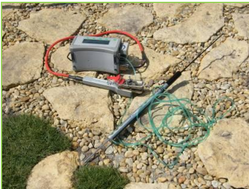
25. ábra: Az infravörös-gázanalizátor készülék (LCi) (Fotó: Sütöriné Diószegi, 2011)
