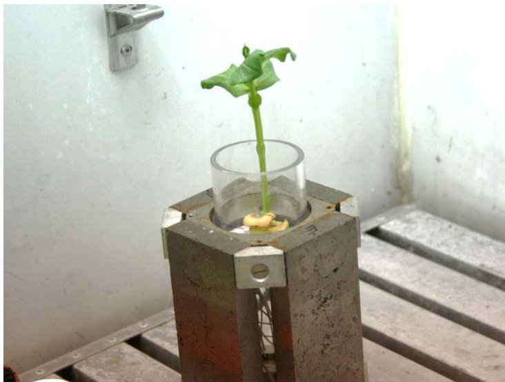
6-8. ábra – A gyökérvizsgálatoknál használt kísérleti elrendezésről készült felvételek. Az elsőn a plexi henger látható az „úszó” növényrel, a másodikon pedig a mágnes hengerben való elhelyezkedése figyelhető meg.
