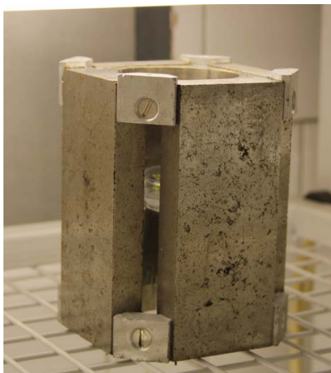
5-4. ábra – A képen az álló hengermágnes oldalnézete látható. A felülről megvilágított, 12 cm hosszú henger (33, ill. 40-42 mT függőleges, homogén mágneses erőterű) belső terének közepén, üveg távtartón helyezkedik el a 3 cm átmérőjű Petri-csésze, melyben a növények nevelkedtek.
