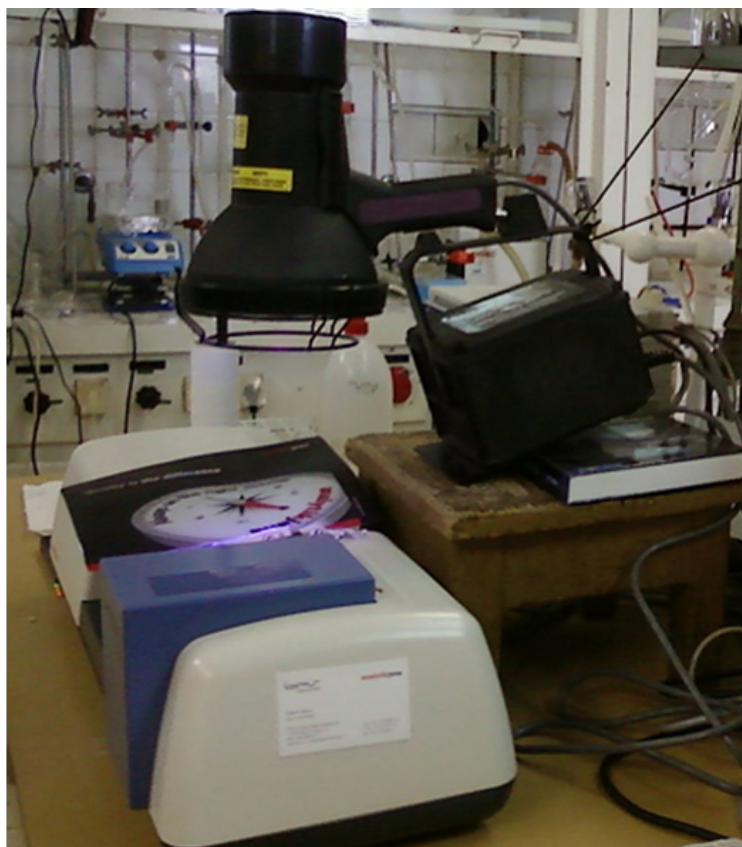
13. ábra: A diódasoros spektrofotométer és a spektrállámpa együttes alkalmazása fotoreaktor fényforrásaként.
