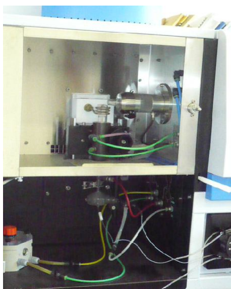
32. ábra. Az ICP plazma tere (torch)
