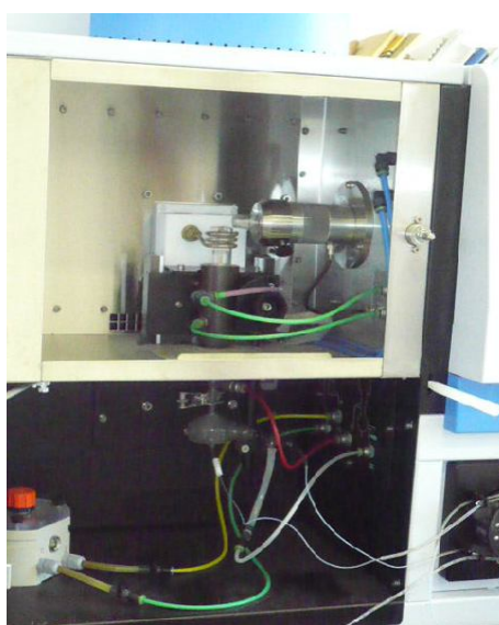
32. ábra. Az ICP plazma tere (torch)
