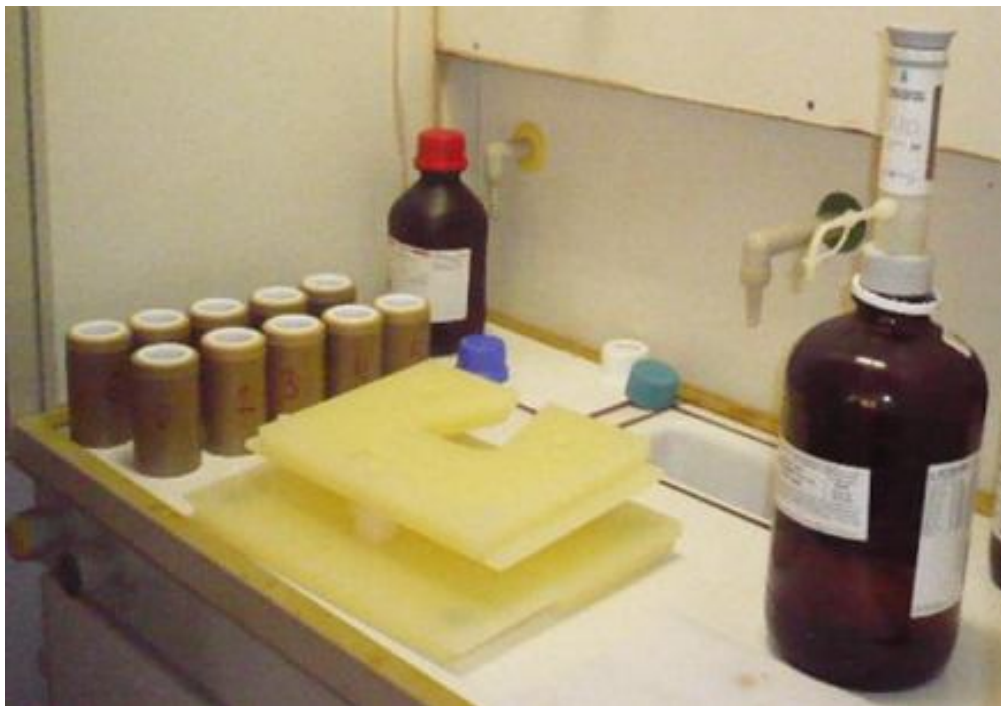
26. ábra. A roncsoló bombák, a hidrogén peroxid és a salétromsav
