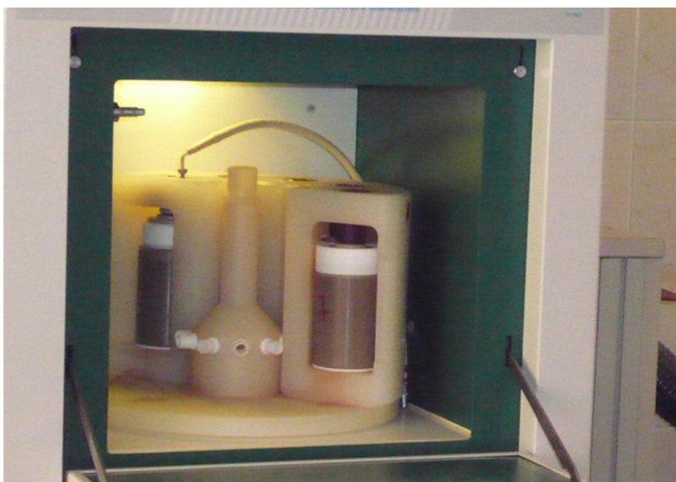
16. ábra. A roncsolóba helyezett bombák
