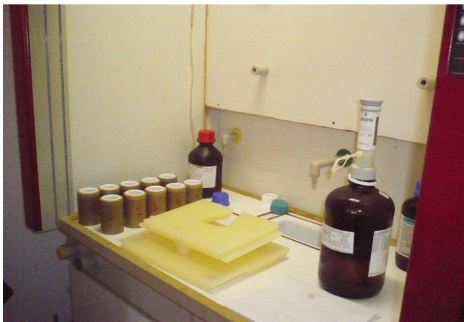
13. ábra. A roncsoló bombák, hidrogén-peroxid és salétromsav
