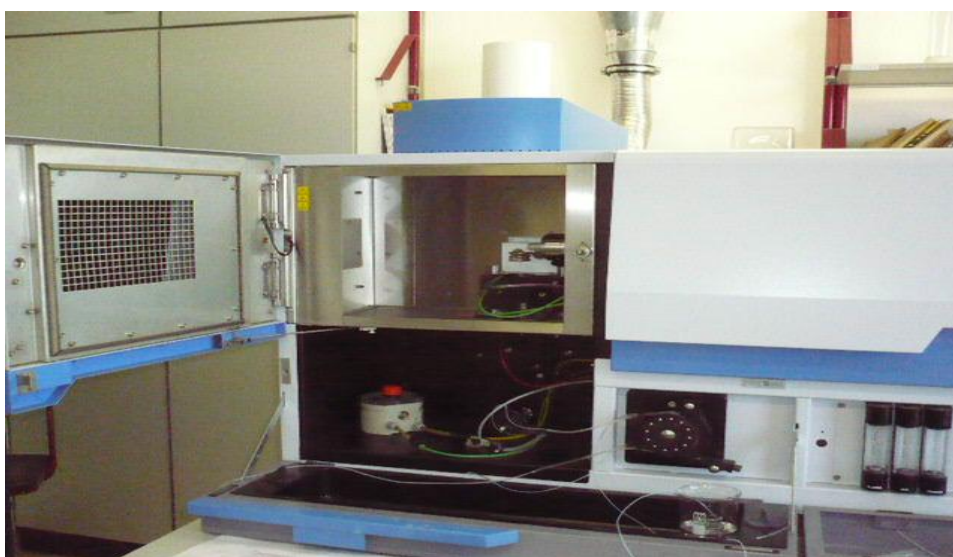
17. ábra. Az ICP plazma-tere (torch)
