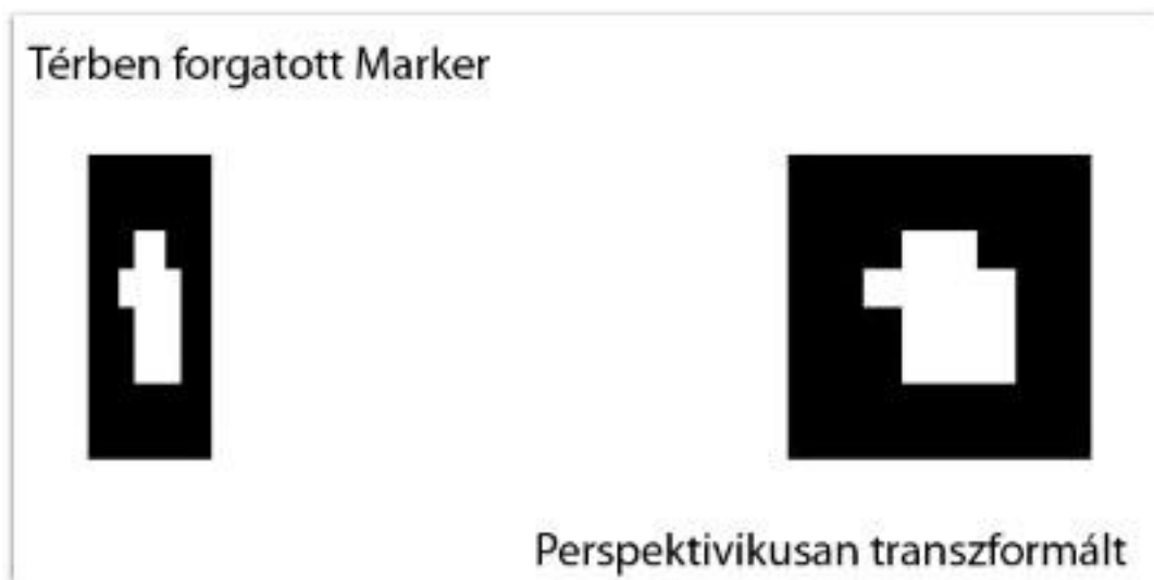
24. ábra Térben elforgatott síkidom visszaállítása eredeti pozíciójába
