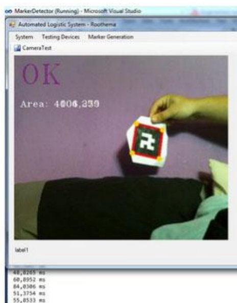
27. ábra Tesztelési kép, enyhén forgatott Marker
