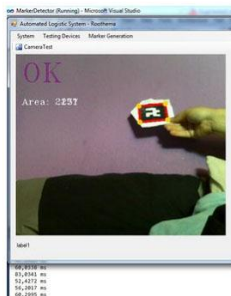
26. ábra Tesztelési kép, erősen elforgatott Marker
