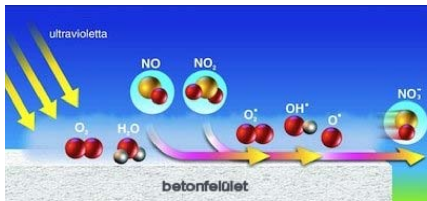
Fotokatalitikus cementtel készült betonfelületek levegőtisztítása
