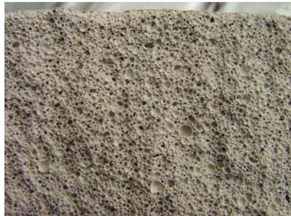
A normál hőmérsékleten szilárduló habbeton pórusszerkezet
