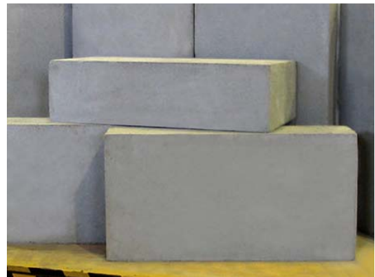
Nanocsövekkel modifikált habbeton
