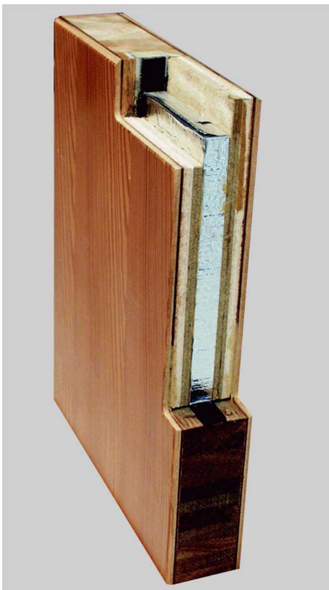
VIP lemezzel hőszigetelt bejárati ajtó vtg.= 45 ÷ 68 mm U = 0,29 \text{ W/m}^2\text{K}
