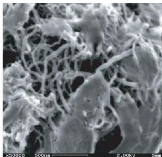
Szén nanocsövek a beton cementkő szerkezetében
