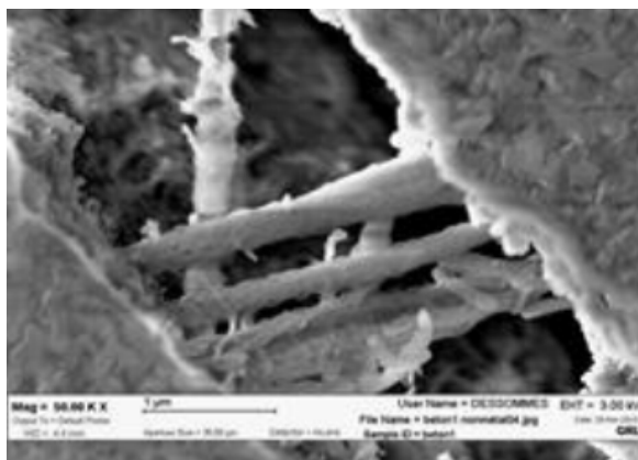
Szén nanocsövek a beton repedéseiben
