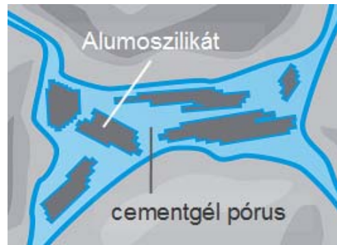
Szilikapor és alumoszilikát adalékanyagok a cementkő pórusvizében
