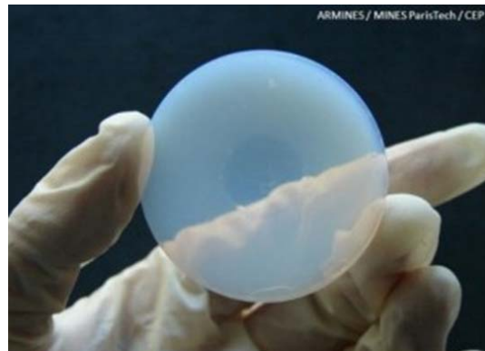
Nanopórusos aerogél hőszigetelő anyag
