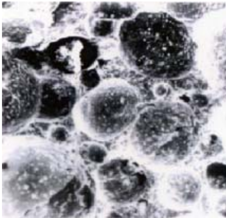
A normál hőmérsékleten szilárduló habbeton pórusszerkezet
