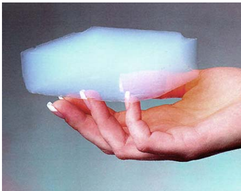
Nanopórusos aerogél hőszigetelő anyag
