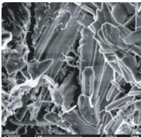
Szén nanocsövek a beton cementkő szerkezetében
