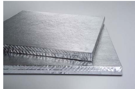
Alumínium védőfóliával borított VIP lemezek
