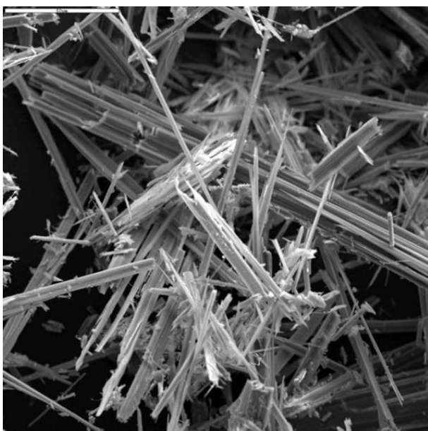
A korábban használatos azbeszt szálak (átmérő: 50 – 3000 nm)
