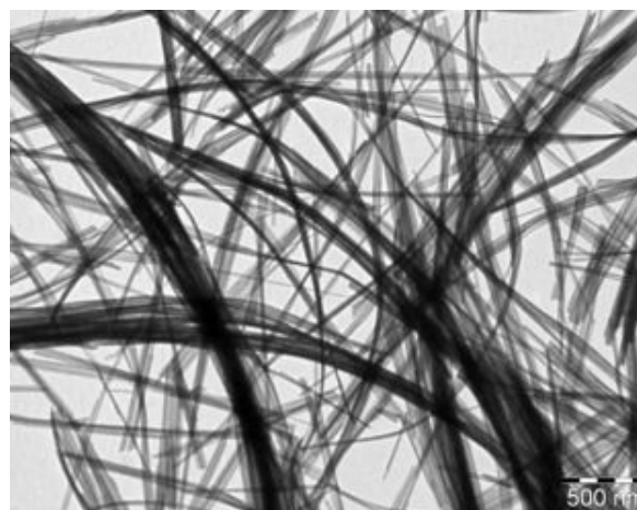
Réteges szerkezetű titanát nanoszálak
