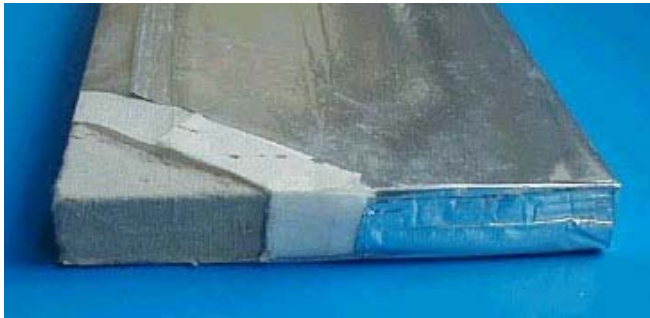
Alumínium védőfóliával borított VIP lemezek
